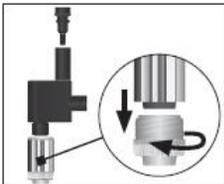
**i** 为确保豪华奶沫器的最佳使用状态，请确保所有部件均被正确牢固地连接。
